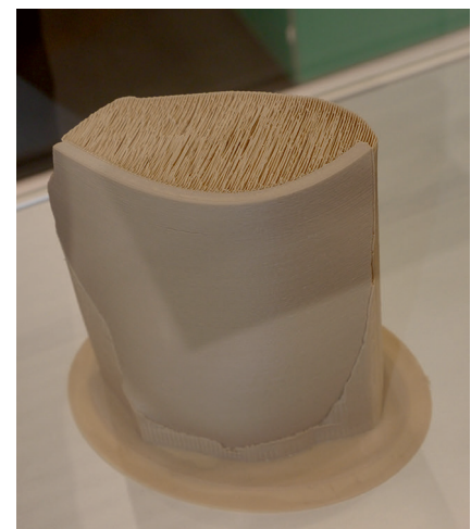
Bild 2. Schädelknochen-Implantat aus PEEK. Die Stützstrukturen dahinter sind so locker aufgebaut, dass sie mechanisch abgelöst werden können. © Hanser / C. Dorlat
